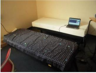
Exemples de nappes de pression (toile avec des capteurs de pression de 10 cm<sup>2</sup>) pour mesurer la pression (en g/cm<sup>2</sup>) exercée sur un matelas, par le corps. Cet essai permet de cartographier les zones de pression et d'identifier notamment les pressions excessives, potentiellement sources d'inconfort (gêne troublant le sommeil) et/ou d'occlusions capillaires sanguins (engourdissement).
