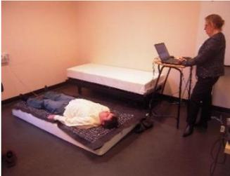
Les zones de pression de tout le corps en position allongée, côté dos (des tests ont aussi été menés sur des dormeurs sur le côté). En sélectionnant ces 2 positions et en mesurant avec 3 percentiles (petite taille, taille moyenne, taille importante), FCBA a pu avoir un spectre suffisamment représentatif de la population.
