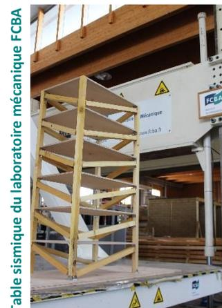
Table sismique du laboratoire mécanique FCBA
